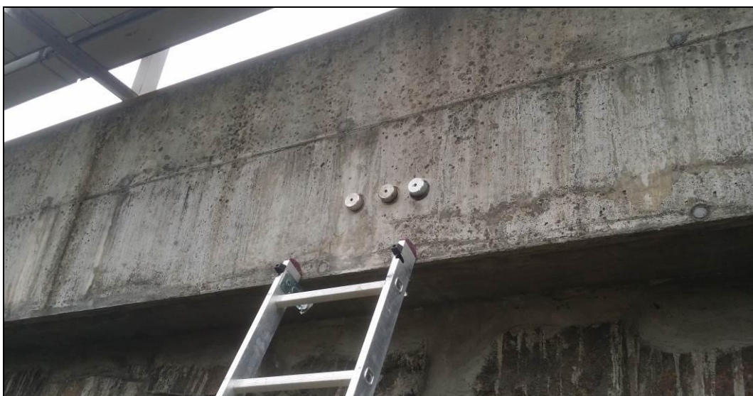
Obr. č. 22 - Odtrhové zkoušky P4 - P6 na římse OZ v km 165,115
