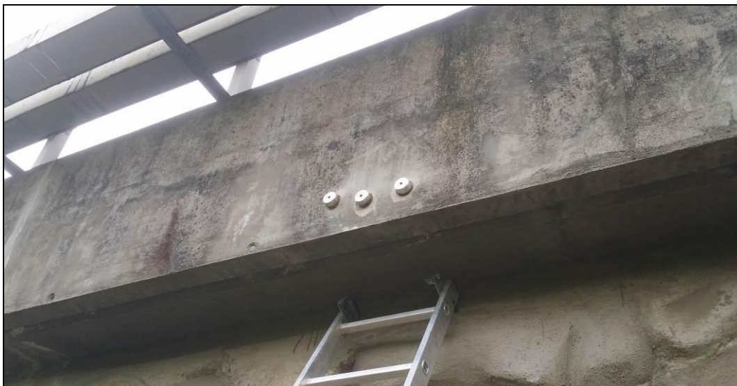
Obr. č. 23 - Odtrhové zkoušky P7 - P9 na římse OZ v km 165,325
