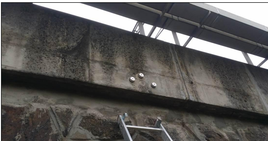
Obr. č. 24 - Odtrhové zkoušky P10 - P12 na římse OZ v km 165,380
